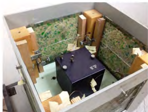
Fig. 7 Arriba: Caja Térmica con fuente de energía activada. Abajo: 8 probetas térmicas instaladas en 4 caras en interior de Caja Térmica
