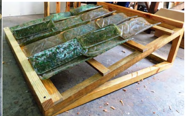
Fig. 12 En la imagen superior se observa como el material tiene buena adherencia en superficies porosas, en este caso se ha pegado con cemento de contacto a un panel de fibrocemento, en la siguiente imagen se observan las diversas placas atornilladas como forro de pared ó celosía. Abajo se muestran las tejas tipo araba instaladas en su estructura al 30% de pendiente.
