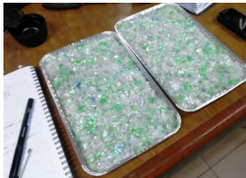
Fig. 4 En laboratorio de Ciencia de los Materiales se realizó la fundición de dos muestra de 500ml con un peso de 231.72 ar cada una
