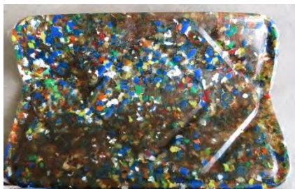
Fig. 8 Puede observarse que al realizar la prueba de impacto con el dispositivo bajo norma, ninguno de los especímenes sufre daños, pero al generarle caída libre a un metro de altura con los dos tipos de masas las tejas soportan la masa más pequeña, no obstante así la de 355.2gr excepto por la teja combinada de PET con PP que no sufre ningún tipo de daño.
