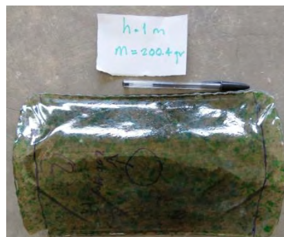
Fig. 8 Puede observarse que al realizar la prueba de impacto con el dispositivo bajo norma, ninguno de los especímenes sufre daños, pero al generarle caída libre a un metro de altura con los dos tipos de masas las tejas soportan la masa más pequeña, no obstante así la de 355.2gr excepto por la teja combinada de PET con PP que no sufre ningún tipo de daño.
