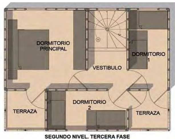
Fig. 8 FASE 3: Crecimiento vertical de prototipo de vivienda con sistemas constructivo Plastipanel y Plástilamina LR. Desarrollado por A. Osorio, M. Quijano C. Bonilla con datos de L. Rodríguez
