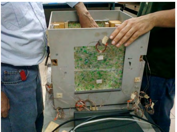
Fig. 8 Columna derecha, arriba de estas líneas: Ensayo de Conductividad térmica, realizado en Caja Térmica con sensores de temperatura, y lector digital.
