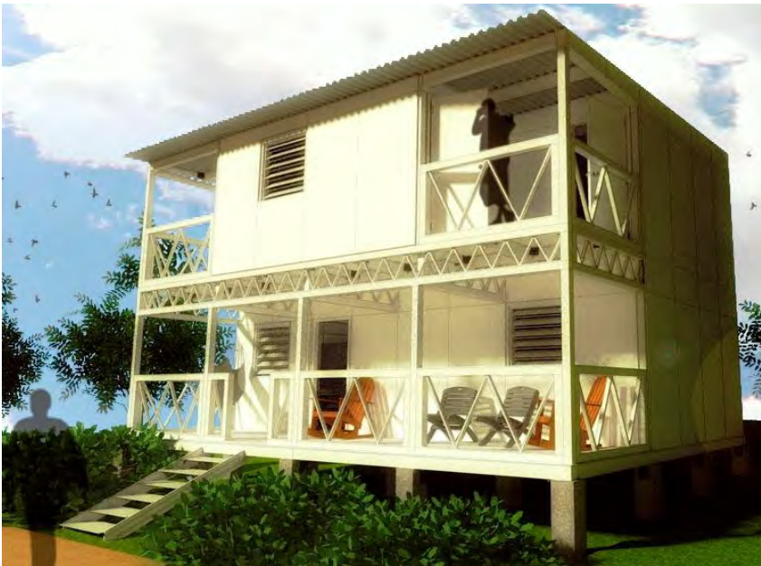
Fig. 7 FASE 2: Crecimiento horizontal de prototipo de vivienda con sistemas constructivo Plastipanel y Plástilamina LR. Desarrollado por A. Osorio, M. Quijano C. Bonilla con datos de L. Rodríguez
