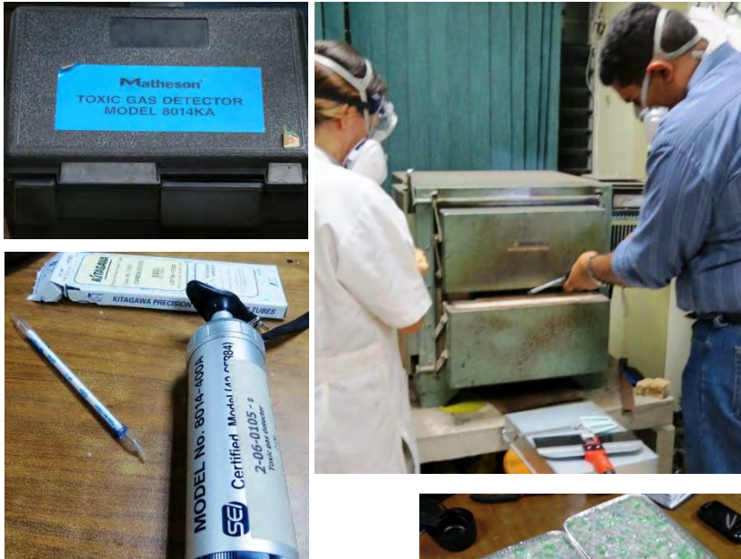
Fig. 4 En laboratorio de Ciencia de los Materiales se realizó la fundición de dos muestra de 500ml con un peso de 231.72 ar cada una
