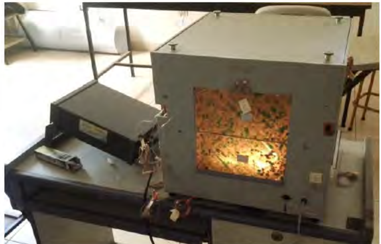
Fig. 7 Arriba: Caja Térmica con fuente de energía activada. Abajo: 8 probetas térmicas instaladas en 4 caras en interior de Caja Térmica
