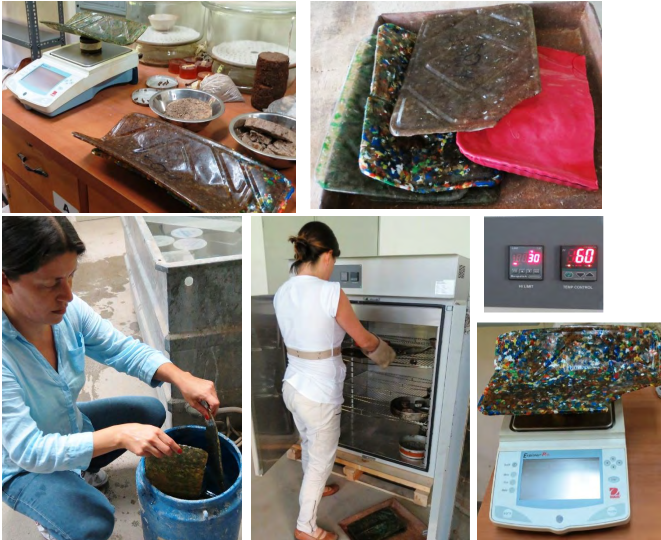
Fig. 7 Puede observarse que se han sometido todo tipo de especímenes de PET reciclado fabricados de diversas formas entre éstos, mezclados con PP y con colorante en el caso de la placa color rojo, elaborada en línea de producción con extrusor. La placa que tiene menor porcentaje de absorción es la placa color rojo y la que tiene mayor porcentaje de absorción es la placa elaborada en mufla combinada con PP ya que ambos materiales no logran fundirse y genera micro espacios el resto de placas tiene un promedio bajo de absorción, en general el material fundido no es absorbente sino, impermeable.
