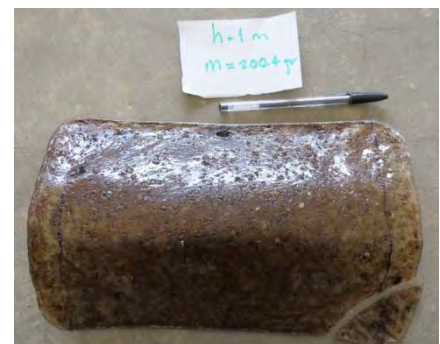
Fig. 8 Puede observarse que al realizar la prueba de impacto con el dispositivo bajo norma, ninguno de los especímenes sufre daños, pero al generarle caída libre a un metro de altura con los dos tipos de masas las tejas soportan la masa más pequeña, no obstante así la de 355.2gr excepto por la teja combinada de PET con PP que no sufre ningún tipo de daño.
