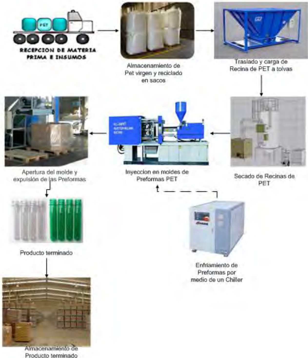
Fig. 17 Diagrama del proceso de fabricación de preformas de PET. Fuente: Elaboración propia
