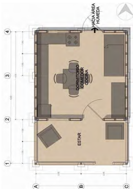
Fig. 6 FASE 1: Unidad inicial de prototipo de vivienda con sistemas constructivo Plastipanel y Plastilamina LR. Desarrollado por A. Osorio, M. Quijano C. Bonilla con datos de L. Rodríguez
