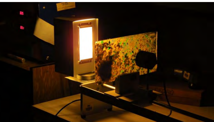
Fig. 8 Columna derecha, arriba de estas líneas: Ensayo de Conductividad térmica, realizado en Caja Térmica con sensores de temperatura, y lector digital.
