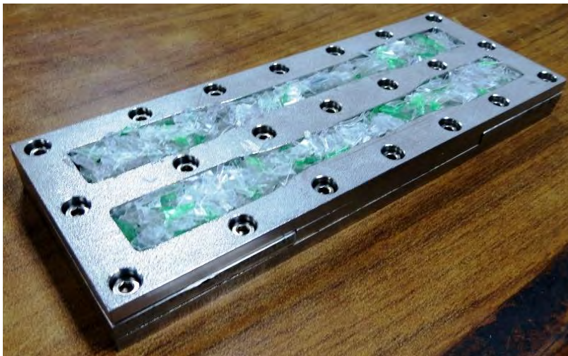
Fig. 10 Molde de acero inoxidable para fabricar probetas mecánicas Fuente: Elaboración propia, Diseño de Florencia Lartategui
