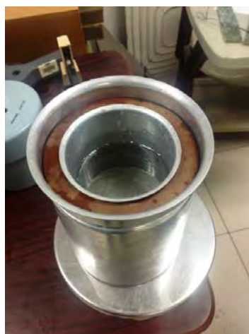
Fig. 9 Ensayo de coeficiente de dilatación
