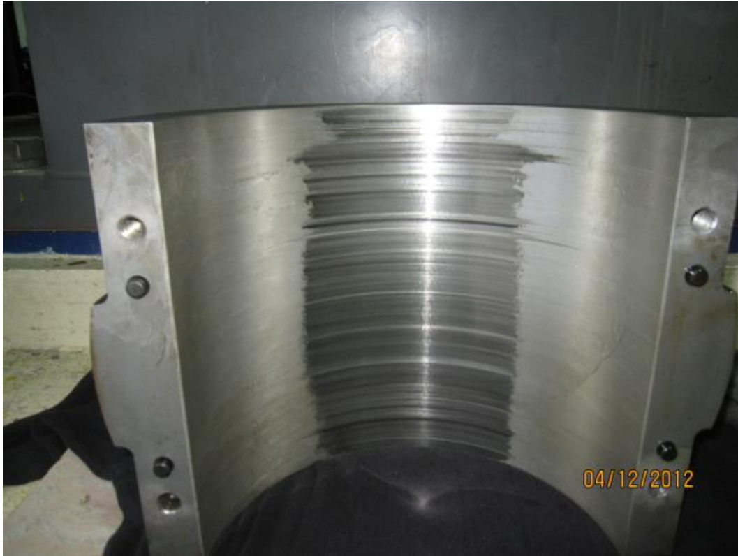
Desgaste en chumacera de babbit de turbina Pelton
