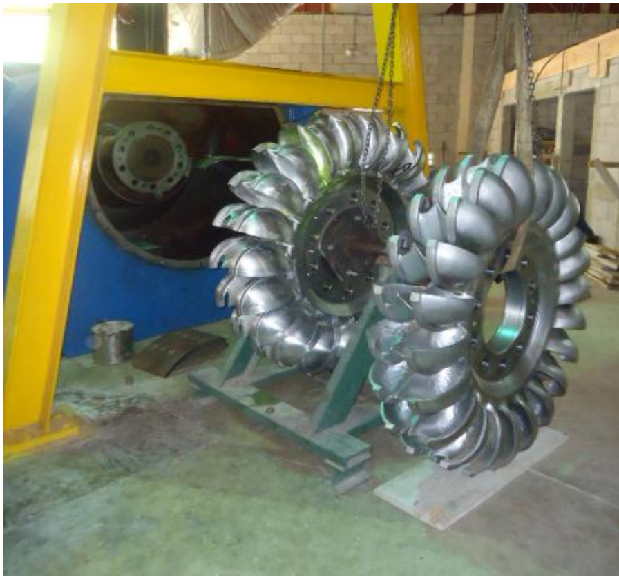
Rodetes de turbinas Pelton desmontados para inspeccionar desgastes
