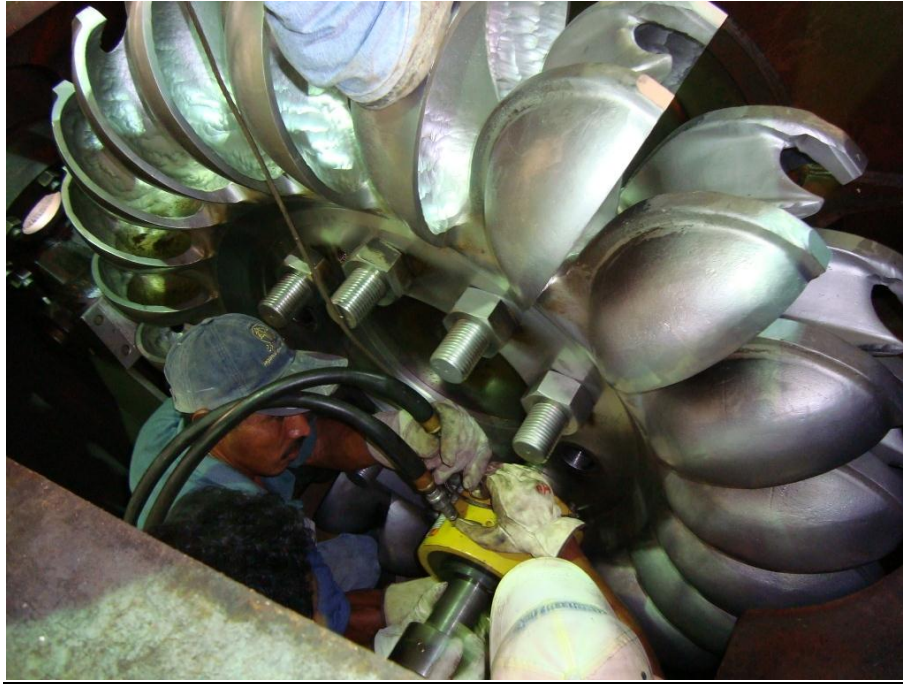
Canjilones que muestran desgaste normal por abrasión
