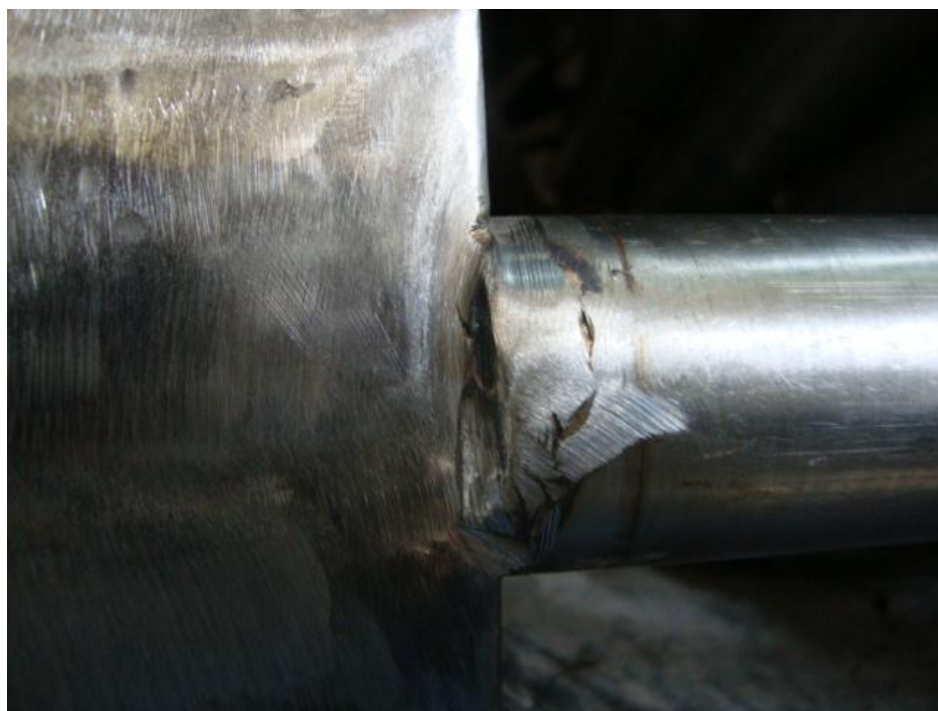
Desgaste en el muñón de un álabe móvil
