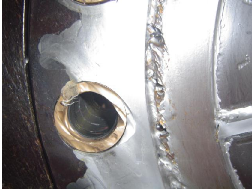
Desgaste en el buje o manguito para soporte de un álabe móvil
