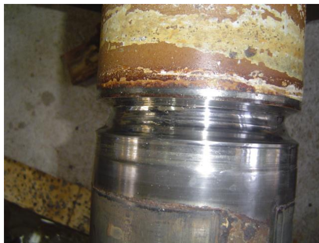
Desgaste del eje de una turbina, antes de modificaciones hechas al sello mecánico
