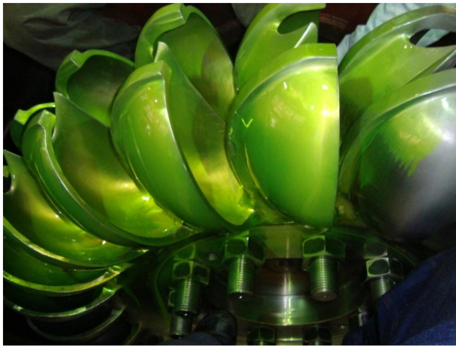
Inspección de rodete Pelton con líquido penetrante
