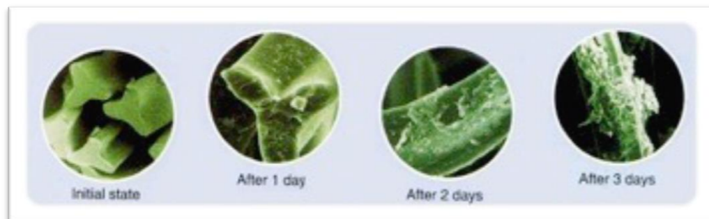
Esquema 2: Proceso de Crecimiento Bacteriano en el Reactor de Película fija
